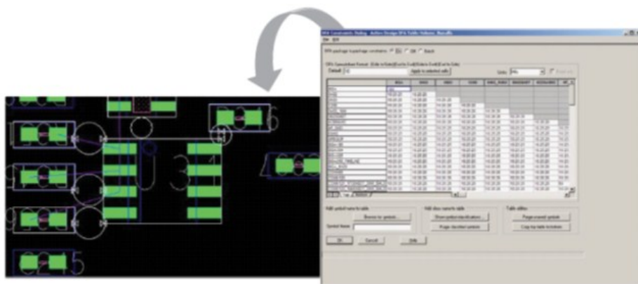
Рисунок. DFA правила и их контроль во время размещения компонентов.
