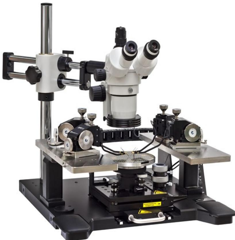
*EPS150COAX* включает все необходимое для точных и достоверных DC-измерений на полупроводниковых пластинах диаметром до 150 мм. Система объединяет в себе лучшие из известных методов снятия вольт-амперных и вольт-фарадных характеристик.
