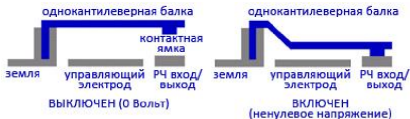
Рисунок 2. Радиочастотный МЭМС-переключатель консольного типа (предоставлен [1])
